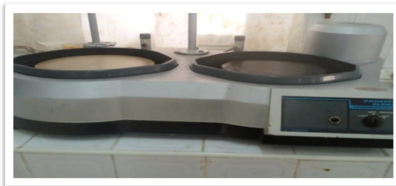
Figure (II.2) : polisseuse de type PHOENIX
