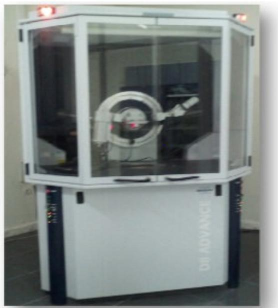
Figure (II.9) : Le diffractomètre de rayons X de type \* BRUKER - AXS type D8\*
