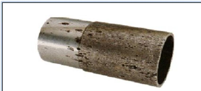
Figure (I.6) : Corrosion par piqûres d'un acier inoxydable[6]
