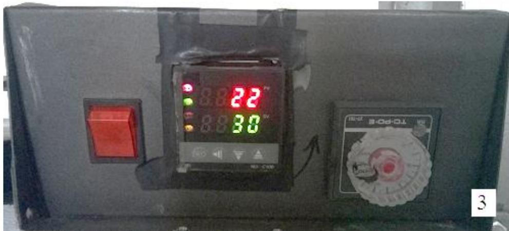
Figure 3.14: Four électrique (3: le thermorégulateur).
