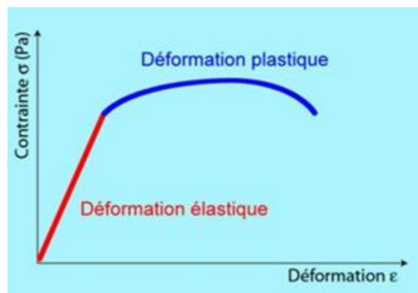
*Figure 1.11: Courbe contrainte-déformation. Domaine élastique et domaine plastique [8].*
