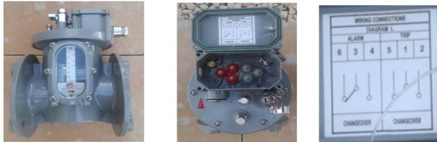
Figure II.8: le dispositif relai bucholz
