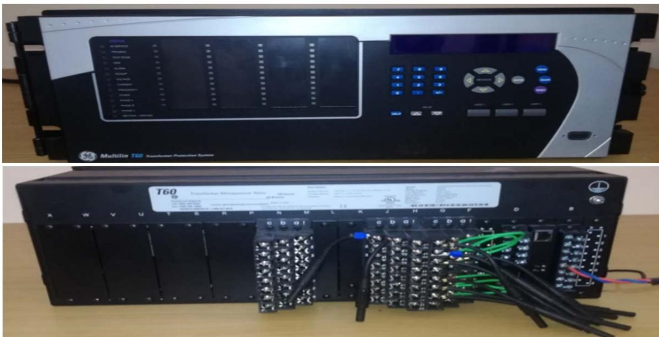
Figure III.15 : relai de protection numérique T60 multifonctions
