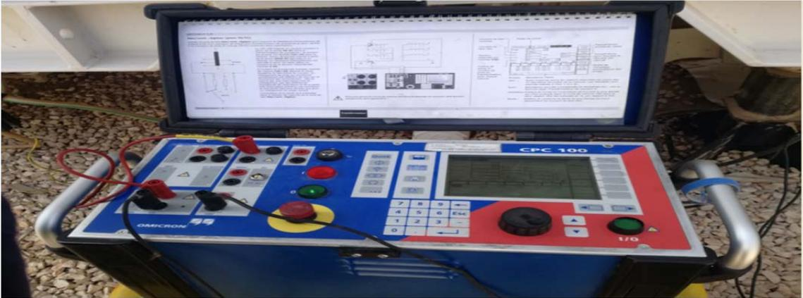
Figure III.4 : caisse numérique d'injection courant CPC 100
