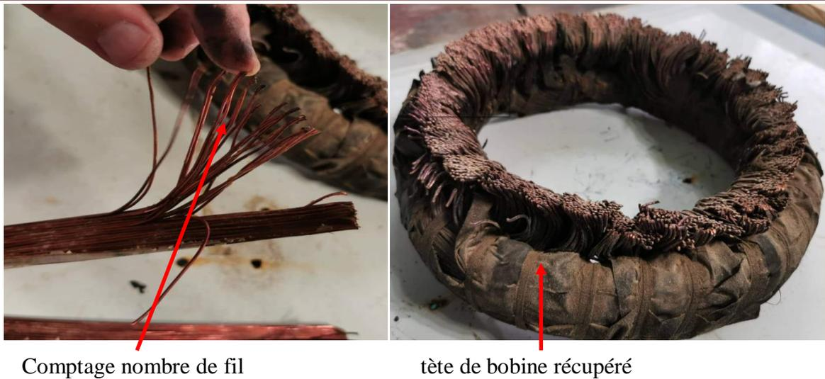
**Fig. IV. 5 :** Chignons récupéré après le débobinage du moteur
