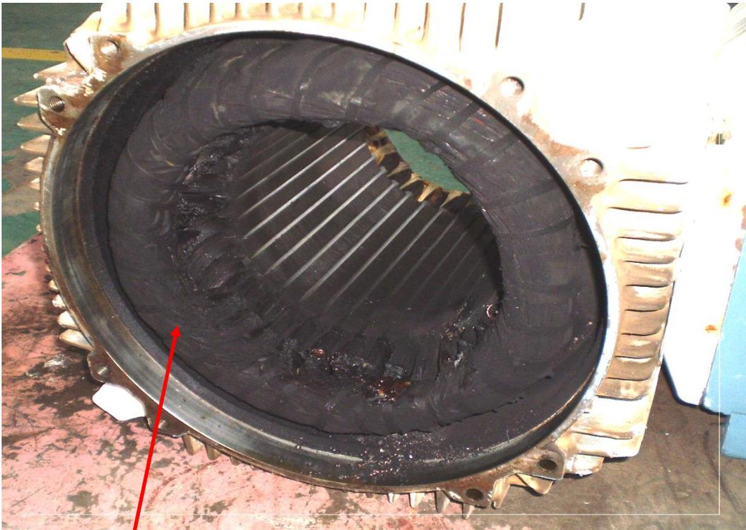
Trace de Charbon sur le bobinage
