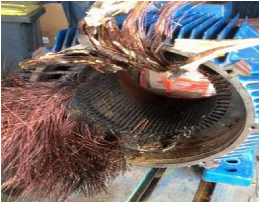
**Fig. IV.2** Débobinage du moteur
