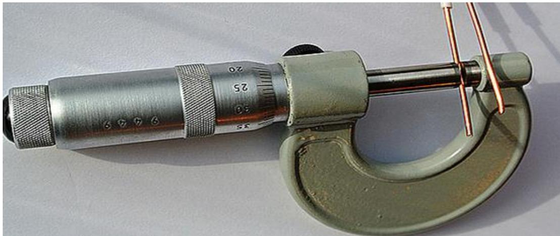
**Fig. IV. 6 :** micromètre (palmer) pour mesure le diamètre fil
