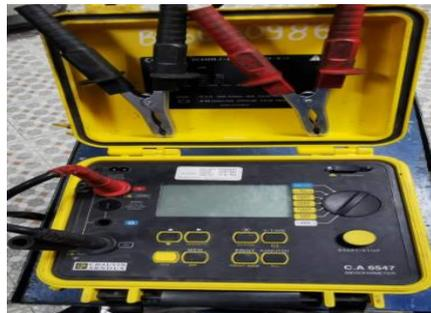
**Fig. IV. 13:** Mégohmmètre C.A 6547 chauvin Arnoux
