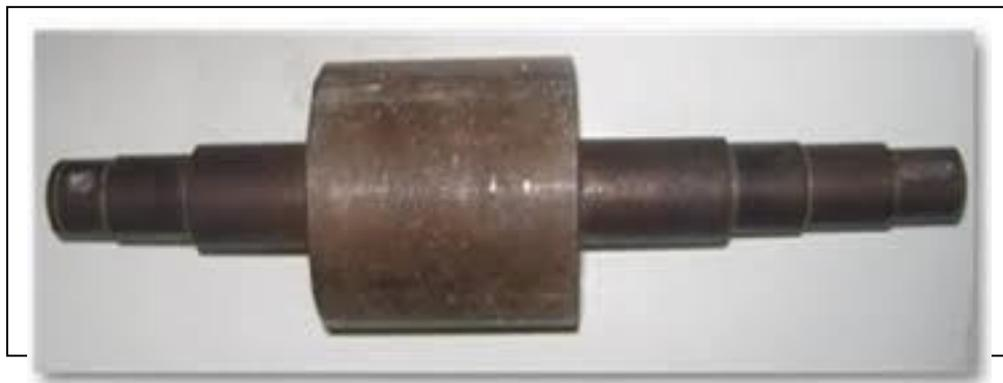
Fig. 1.5. Rotor massif lisse
