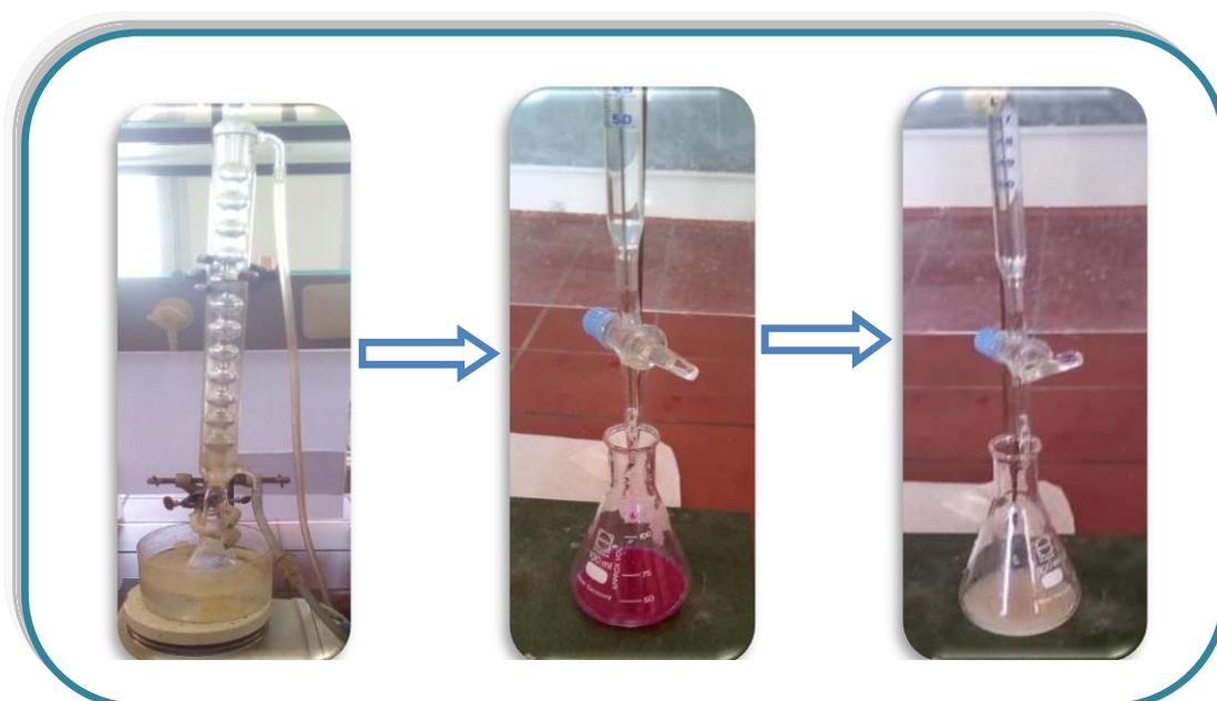
**Figure IV.5** : Différentes étapes suivies pour déterminer l'indice de saponification des graines ( $I_{SGr}$ ).
