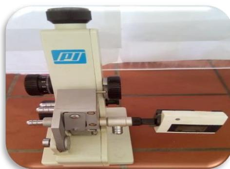
**Figure IV.7 :** Réfractomètre utilisé pour déterminer  $n_D$
