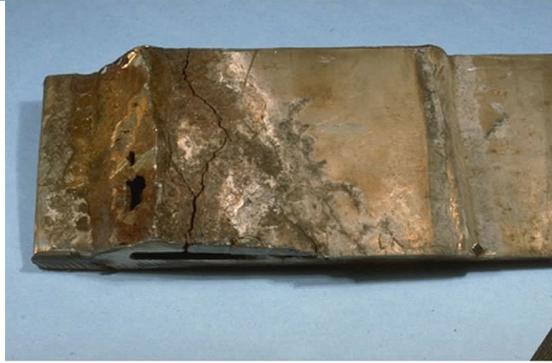
Figure .I.10: la corrosion sous contrainte[10]
