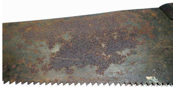
***Figure. I.6 : la corrosion par piqûres[10]***
