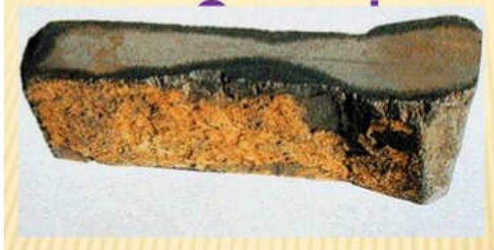
***Figure .1.8 : la corrosion sélective[10]***
