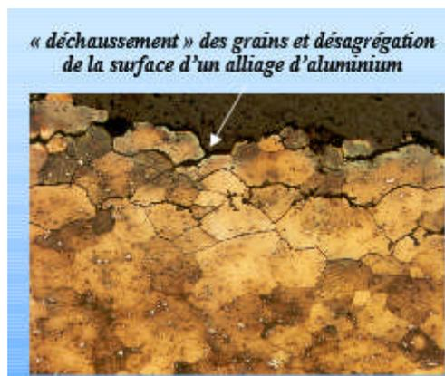
***Figure .I.7: la corrosion intergranulaire[10]***
