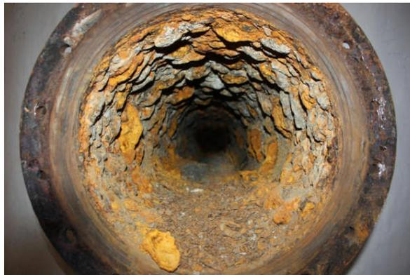
***Figure .1.9 :la corrosion érosion[10]***
