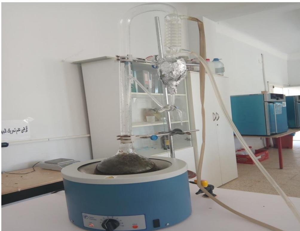
**Figure 14.** Montage de l'hydro distillation de type (Clevenger 1928) (Photo original).
