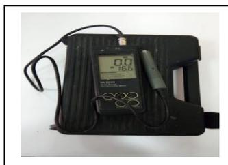
Figure 23 : conducti-mètre
