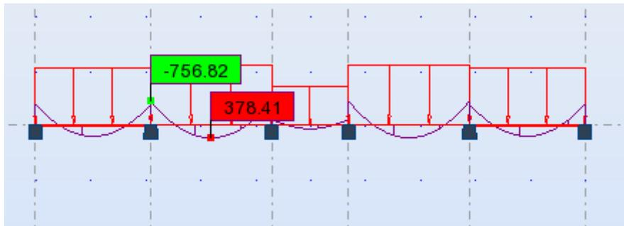
Figure VII.8:Schéma statique des moments dans la nervure a l'ELU
