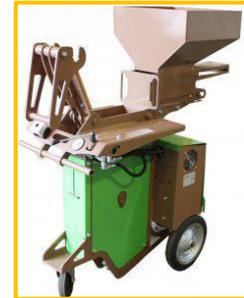
FIGURE 2.22 : Le presse mécanique de BTC
