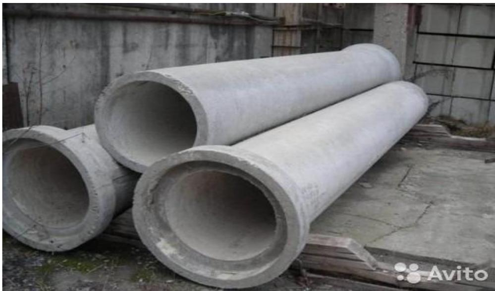
**Figure 2-1-** Conduites en Amiante ciment <sup>[g]</sup>
