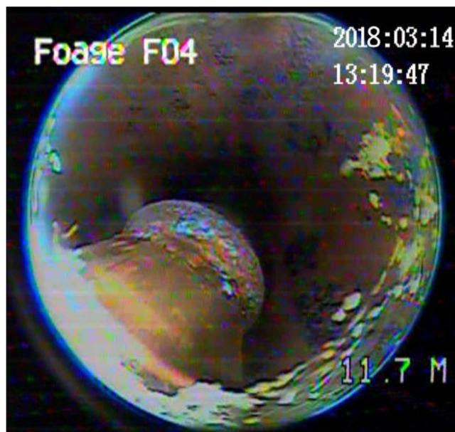
Figure IV.15 : Raccord des conduites de 5 m
