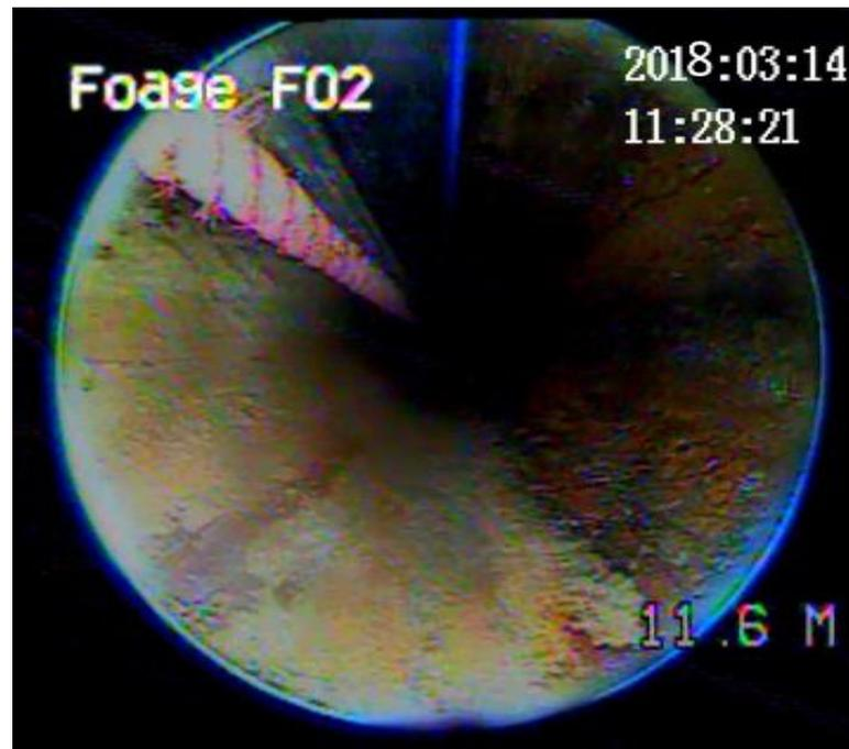
Figure IV.8 : Corrosion du tubage
