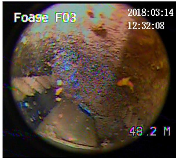
Figure IV.14 : Limite de l'auscultation à 48,2 m
