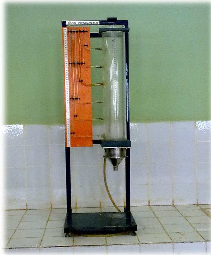
Figure. III.6. Perméamètre à charge constante utilisé
