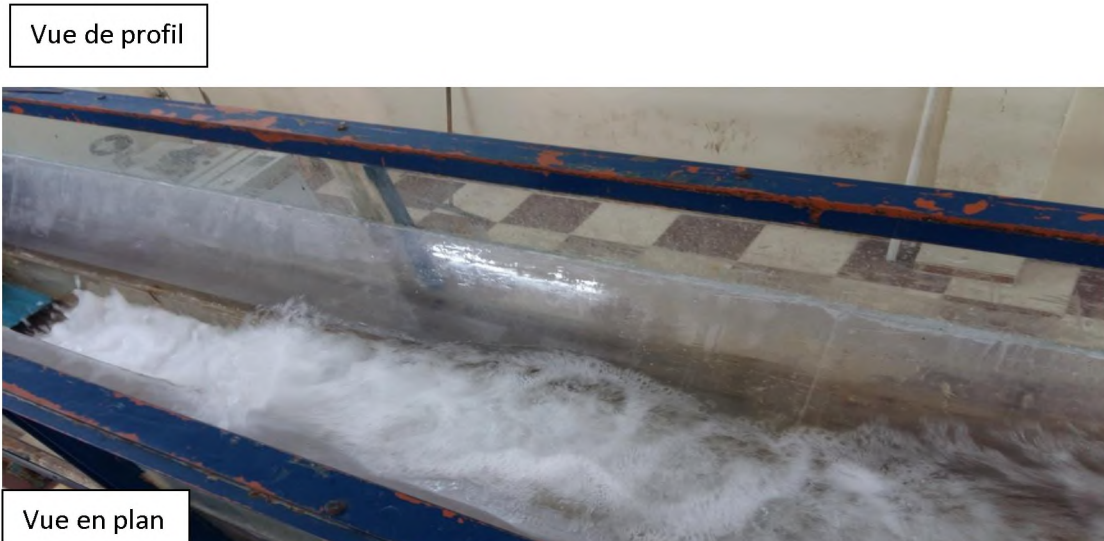
Figure 2.2.b Formation du ressaut en canal trapézoïdal composé à base rectangulaire S=16\text{cm}, h_1=3\text{cm}, h_2=29.5\text{cm}, F_1=6,90
