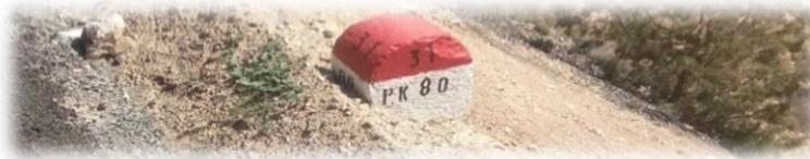
Le pk 80 : ressemble beaucoup au précédent. Il présente l'élévation de la corde chaussée au niveau du terrain naturel ce qui représente un danger pour les véhicules. Le cas où les véhicules soient en pannes dans ce tronçon cela bloque la circulation et personne ne peut y continuer le trajet, car la route est très rétrécie.
