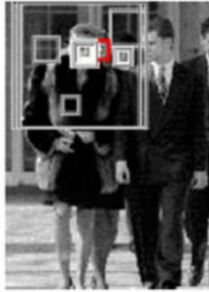
Figure IV.12 : Elimination à tort (détection marquée en rouge) par l'heuristique éliminant les détections débordant sur des visages détectés
