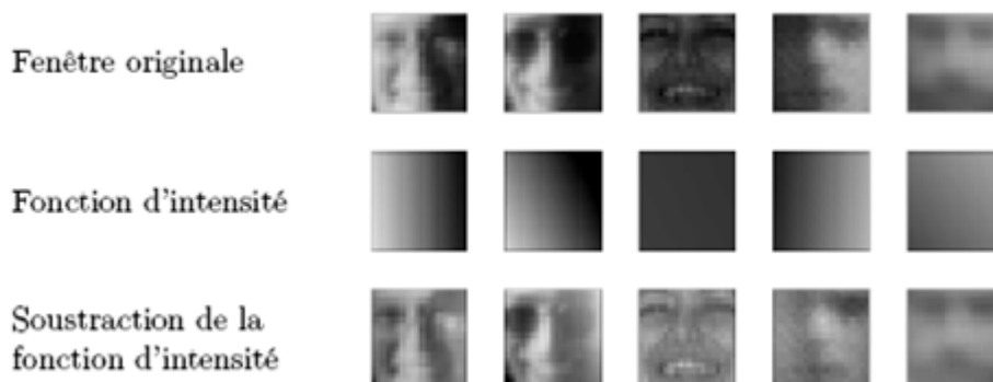
Figure IV.4 : Calcul et application du filtre d'égalisation d'intensité
