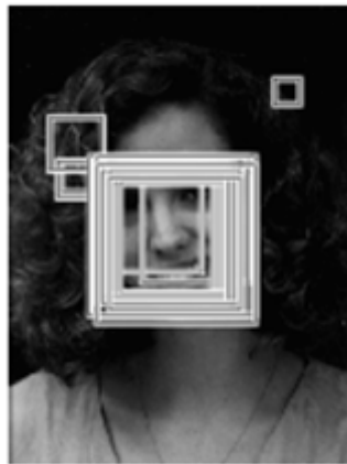
Figure IV.11 : Détections multiples de visages et erreurs isolée
