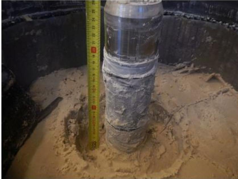
Figure 1-11 – Photo montrant l'emplacement des prélèvements annulaires de sable autour de la crépine (Feia2015)
