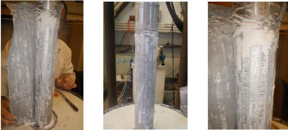
Figure 1-16 – Vues de la crépine pendant le démontage (Feia2015)
