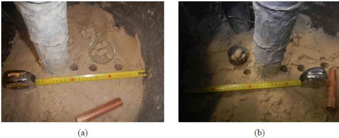
Figure 1-12 – Photos des zones de prélèvements : (a) carottages sur différents rayons ; (b) carottages symétriques par rapport à l'axe de la crépine (Feia2015)
