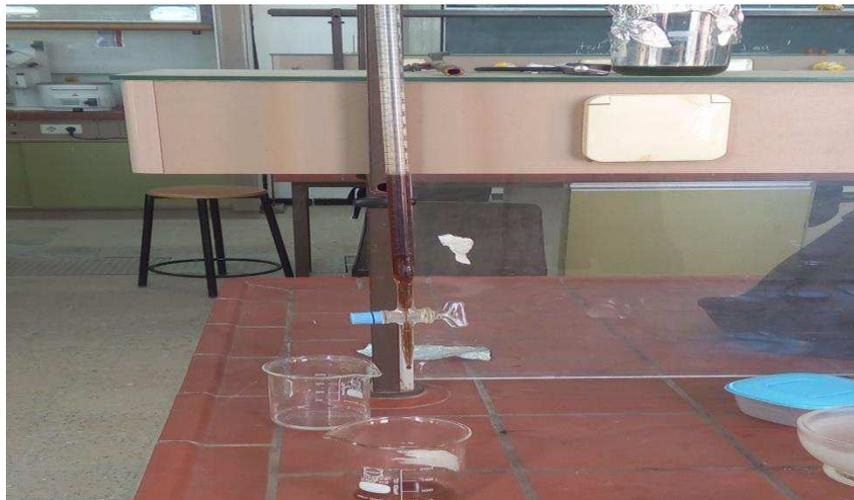
**Figure 12 : mesure de la viscosité.**
