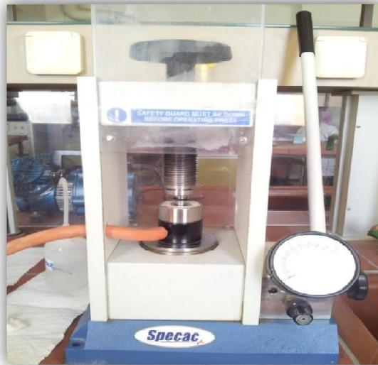
**Figure II.6:** Une presse hydraulique
