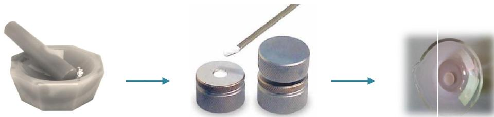
**Figure II.5** : Préparation de la pastille (KBr + échantillon) pour analyse infrarouge.
