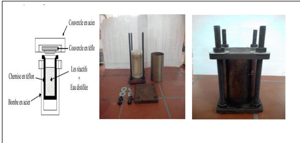
**Figure II.1:** photo et Schéma d'un autoclave.
