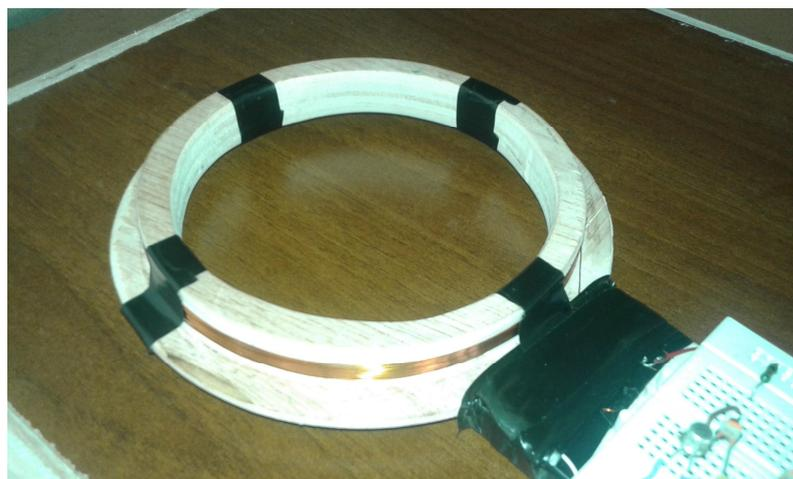
Fig.III.7. Bobine d'émission
