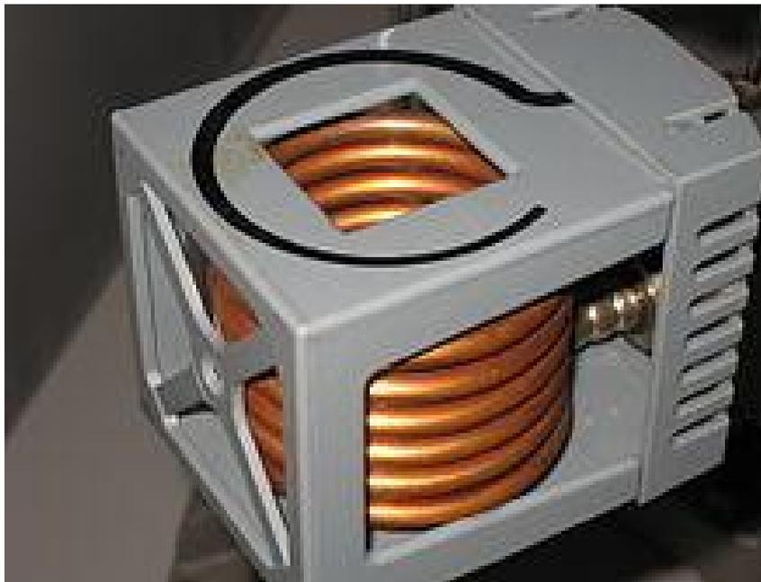
Fig.II.5 : Bobine à air
