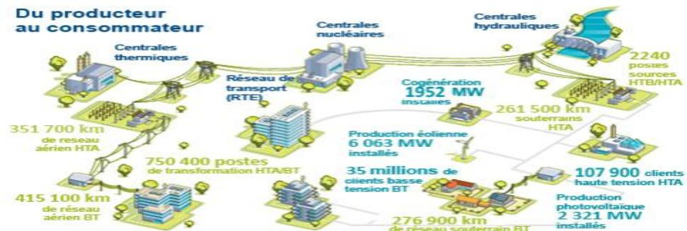
Fig. (I.1) Topologie d'un réseau électrique moderne
