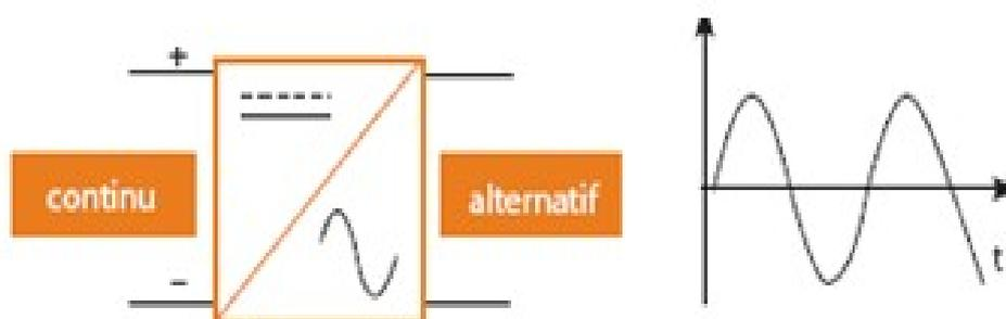
Figure2.12 Onduleur sinusoïdale
