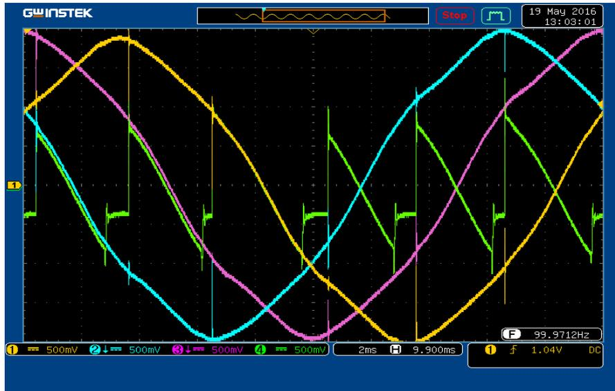
Figure III.17: la tension redressé de la charge et la tension composé
