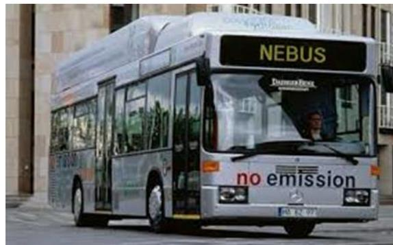
*Fig.1.5*Utilisations les piles combustibles pour les véhicules lourds [6]
