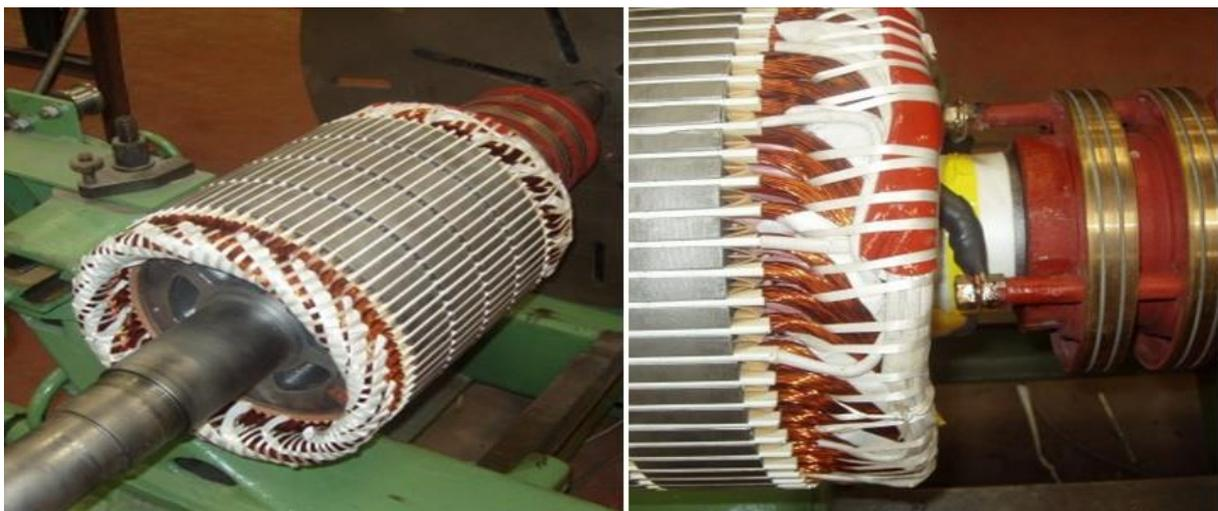
**Fig.I.4.** Rotor bobiné d'une machine asynchrone.
