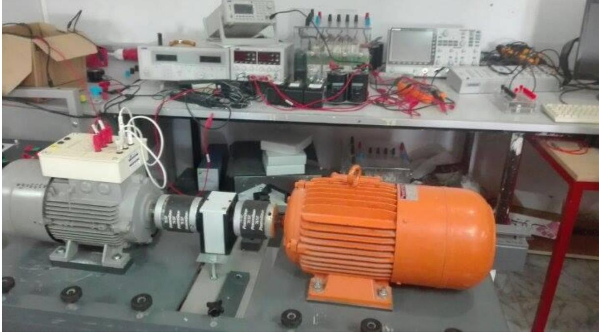
**Fig.III.1** : Banc d'essais expérimental pour l'estimation de la vitesse.
