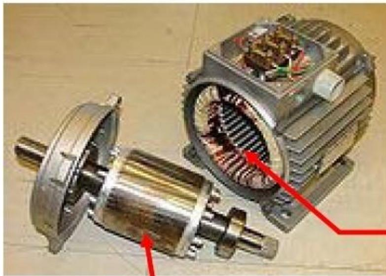
**Fig. I.7 :** Photo réelle d'un moteur asynchrone.
