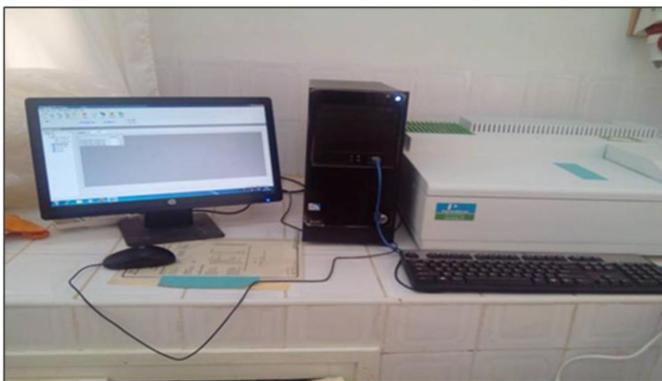
**Figure 9:** UV / VIS spectrophotomètre lambda 25.
