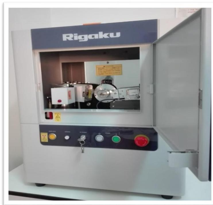
**Figure II.1:** The diffractometer used type Rigaku mini Flex 600.
