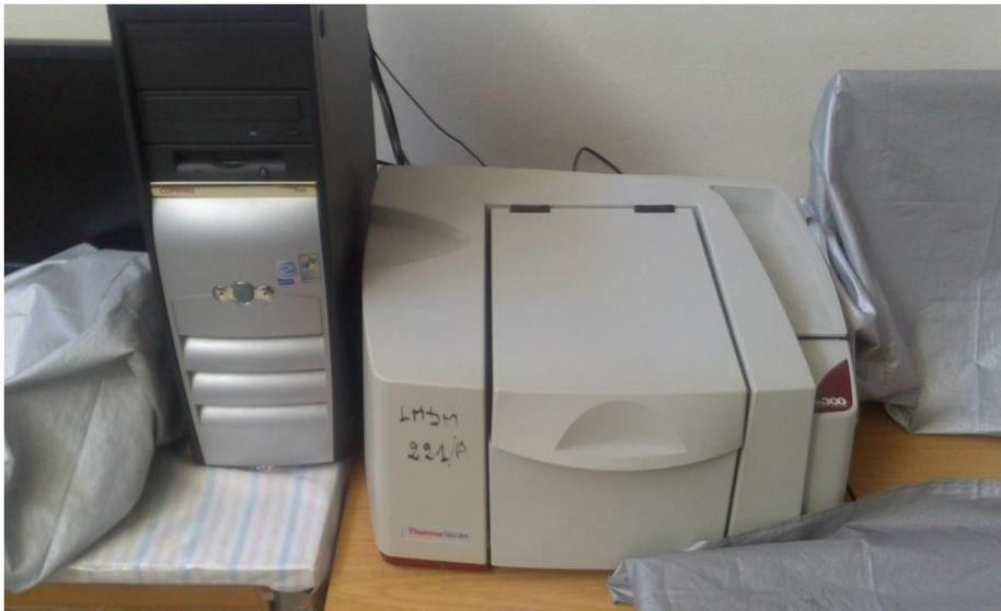
Figure II.6 : Spectrophotomètre FTIR. [3].
