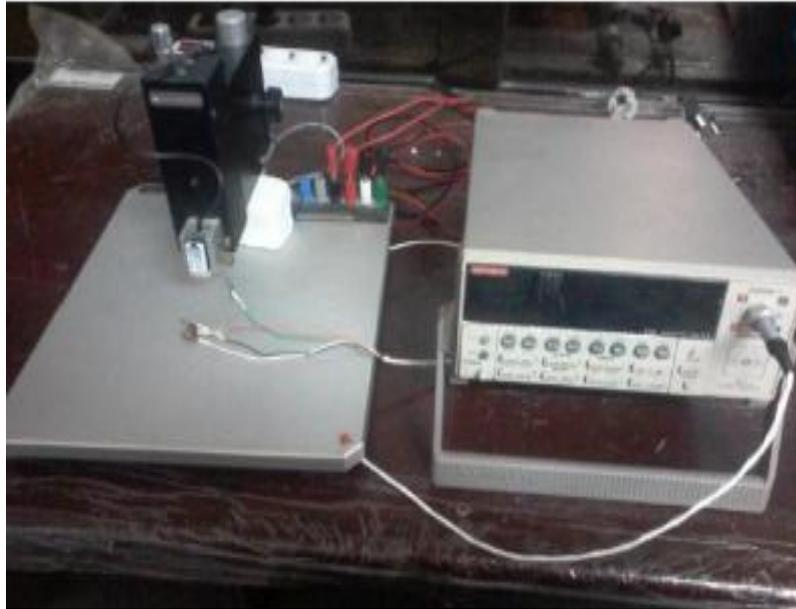
**Figure II.7:** Dispositif quatre pointes [15].
