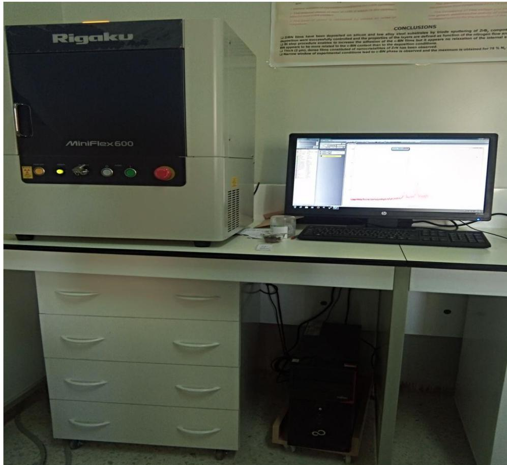
**Fig. II.11:** *Diffractomètre du type Rigaku-MiniFlex 600*
