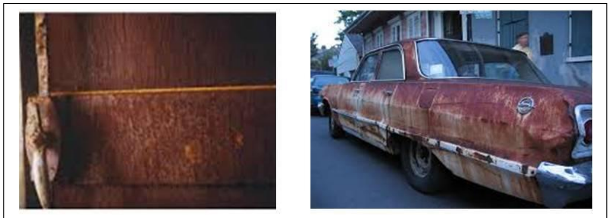
Fig.I.2. Corrosion uniforme : exemple d'une porte et d'un véhicule corrodés [6].
