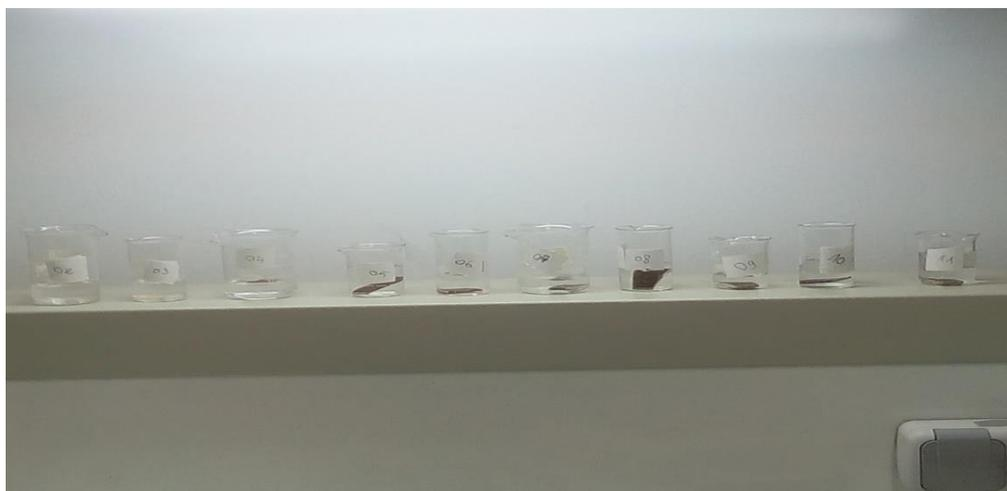
Figure IV.7 : Tests d'absorption d'eau distillée.
