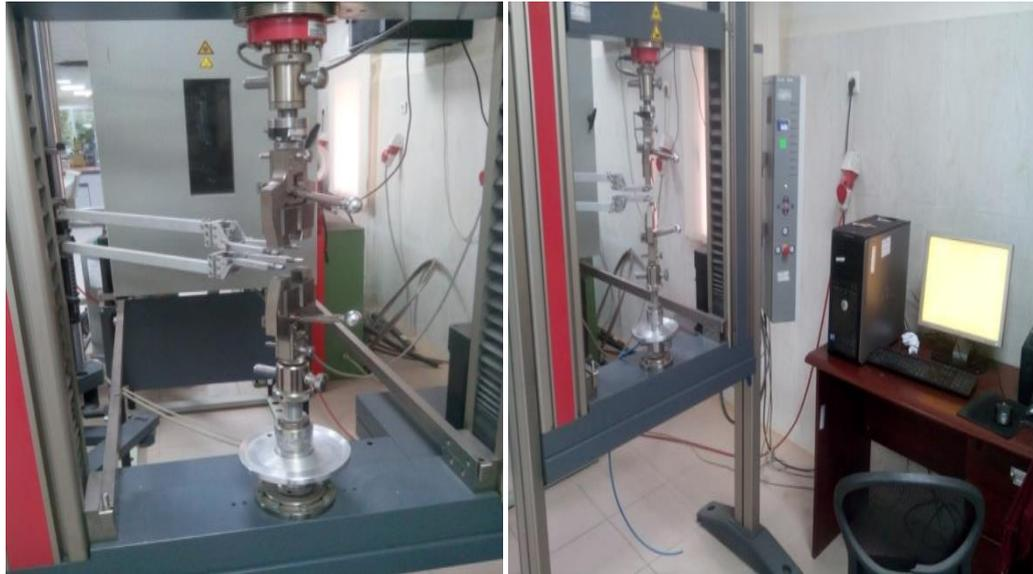
Figure IV.4 : Machine de traction Zwick/Roell.
