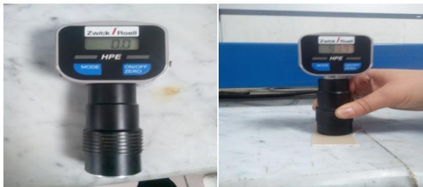
Figure IV.6 : Le duromètre utilisé.
