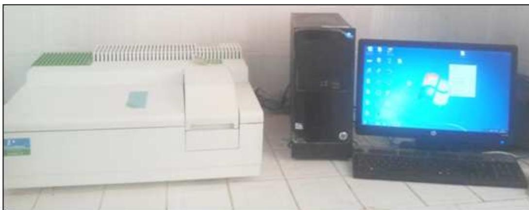
**Figure II.1:** Le spectrophotomètre Ultraviolet-Visible (UV/Vis) SHIMADZU type UV mini 1240
