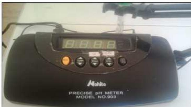
Figure II.2: pH-mètre model Nahita NO-903.
