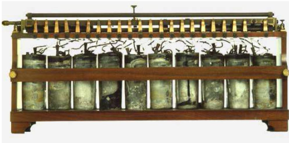
Fig 1.9: Première batterie d'accumulateurs conçue par Gaston Planté [Zan10].
