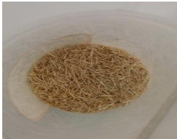
**Figures III.6.b : lamelles des tiges de dattes**
