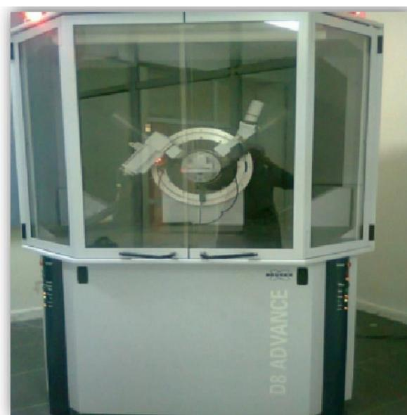
**Figure II.6.** Diffractomètre BRUKER-AXS type D8 ADVANCE.
