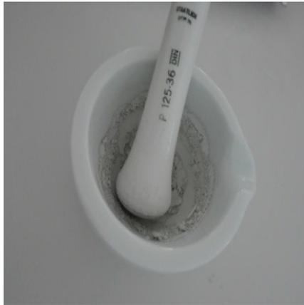
**Figure III.3.** Mélange et Broyage des échantillons dans un mortier.
