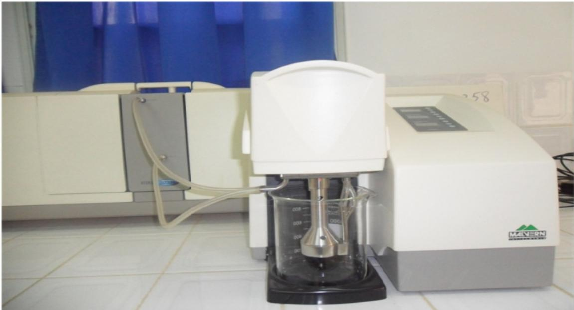
Figure II.9. granulomètre laser Malvern Mastersizer 2000/3000.
