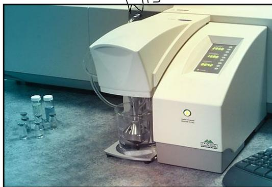
*Figure II.7 : Granulomètre laser Malvern Mastersizer 2000.*
