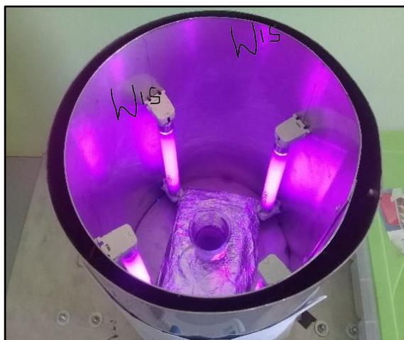
**Figure II.11 :** Photo-réacteur avec des lampes UV et visibles.
