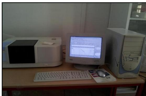
*Figure II.6 : Spectromètre infrarouge type SGIMADZU.*
