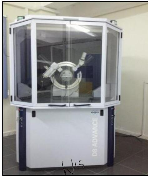
*Figure II.5 : Diffractomètre de rayons X de marque D8 Advance Bruker.*
