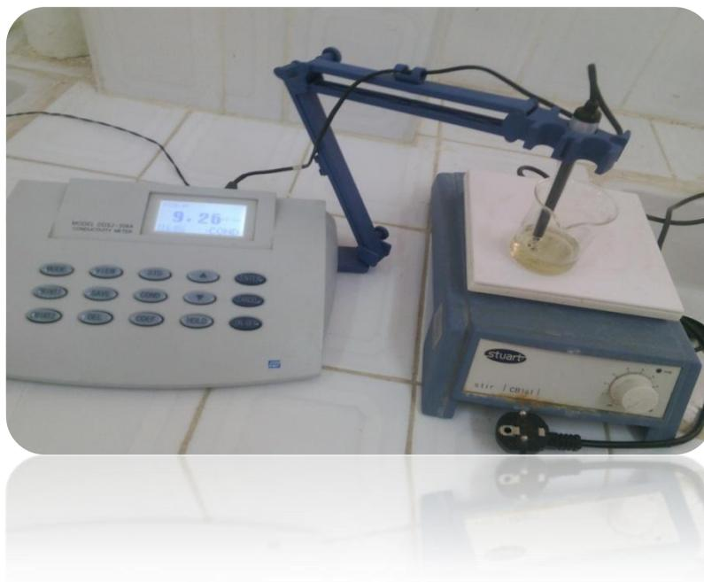
**Figure I.21:** conductimètre de type DDSJ-308A.
