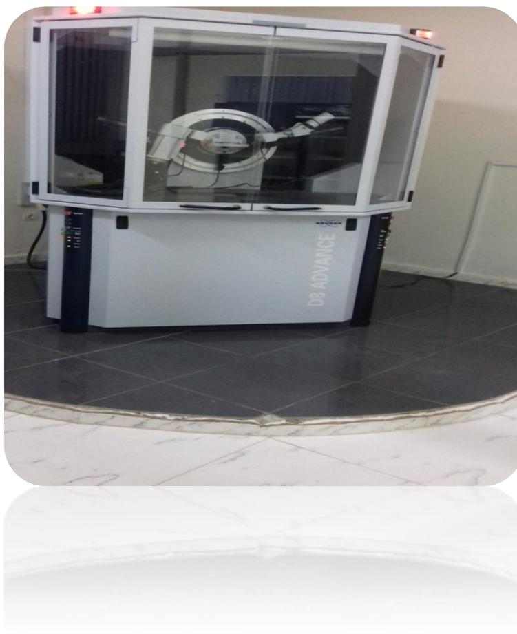
**Figure I.23** : Appareil de diffraction de rayonne X(DRX).
