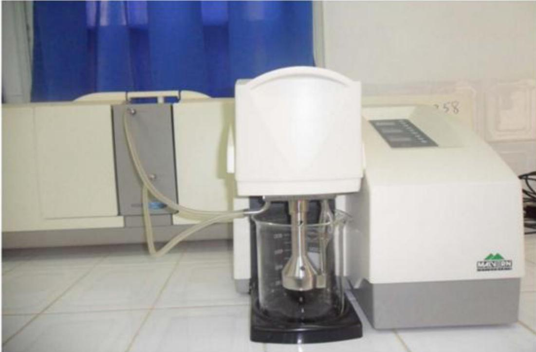
**Figure III-4.** Granulomètre Laser Malvern Mastersizer 2000 pour la granulométrie
