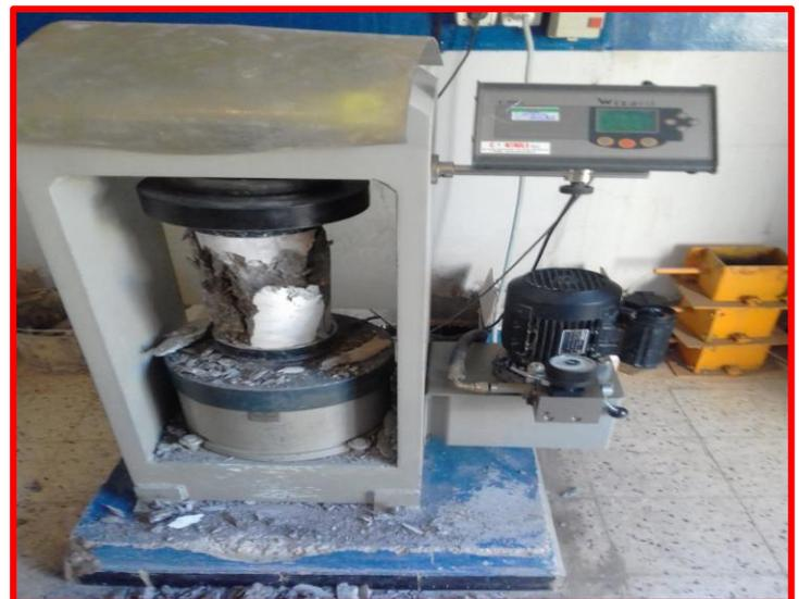
**Photo n°46, 47, 48, 49 : Essai de l'écrasement**
