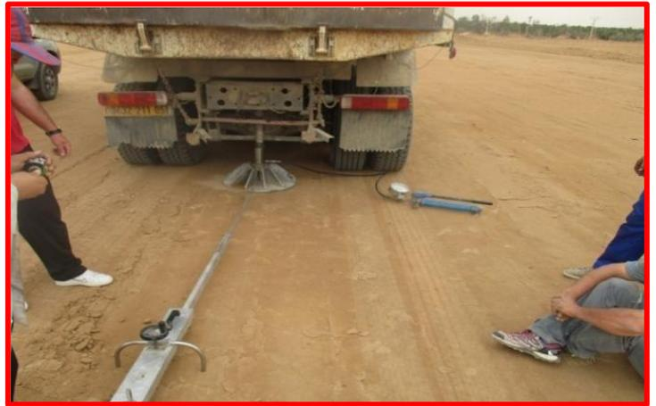
**Photo n°44,45 : Essai de plaque**
