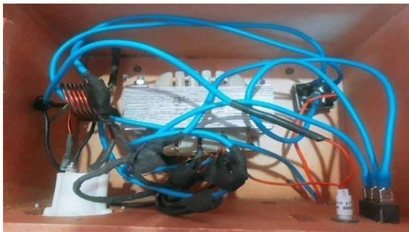
Fig. III.4: chargeur de batterie a l'int rieur
