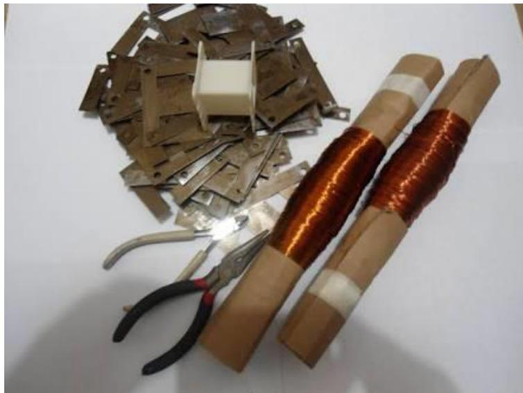
Fig. III.1 : les outils de l'enroulement un transformateur
