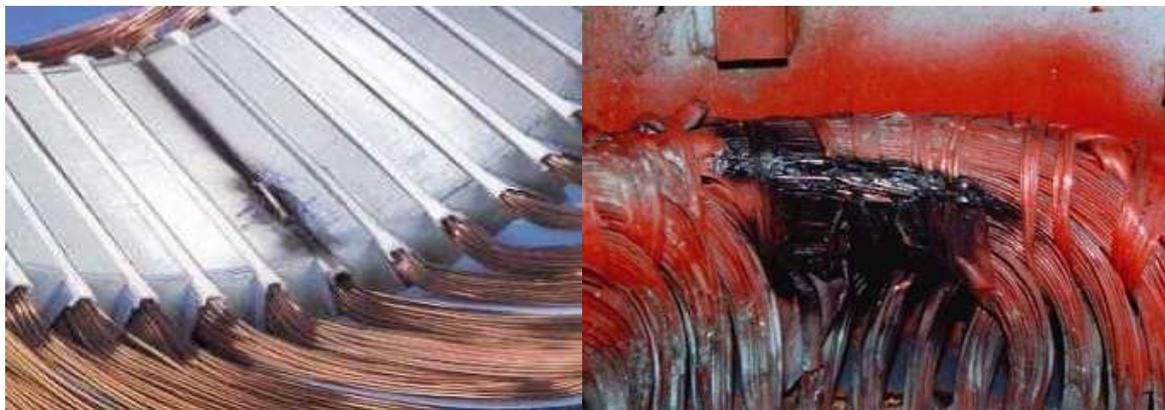
**Fig. I.4 : Exemples de dégâts dus au défaut de court-circuit statorique d'un moteur asynchrone.**
