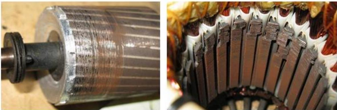
**Fig. I.6: Exemples de dégâts aux stators et rotor dus au défaut de roulement d'un MSA**
