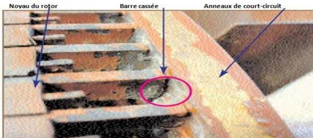
**Fig. I.5 : Exemple d'un défaut de cassure de barre d'un moteur asynchrone**
