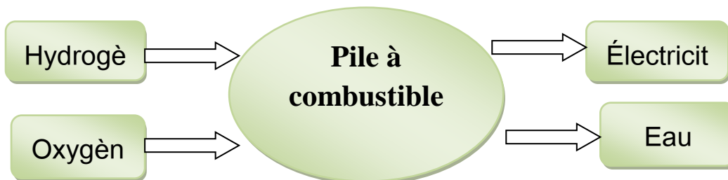
Figure I.4 : principe de pile à combustible
