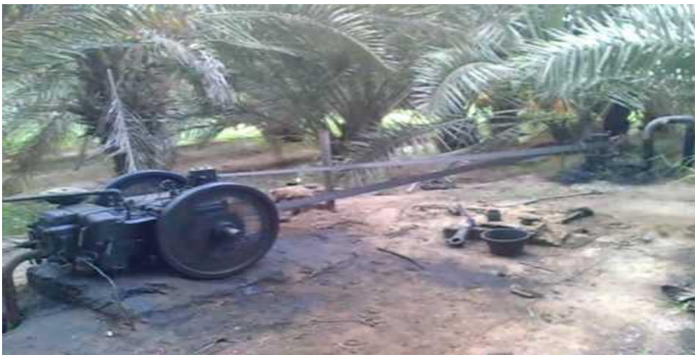
Figure III.24 : Extraction d'eau avec un moteur diesel
