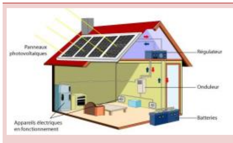
Figure I.7 : Système solaire photovoltaïque
