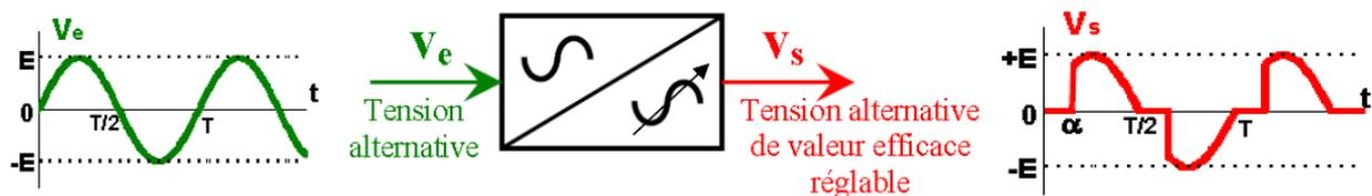
Figure II.8 : Schéma de principe de la conversion Alternative - Alternative (AC – AC)
