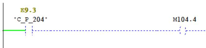
**Réseau 3**: Alarme 'détecteur de température'
