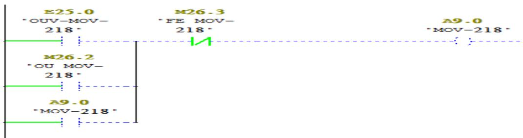
Réseau 6 : L'ouverture et la fermeture de l'électrovanne 219
