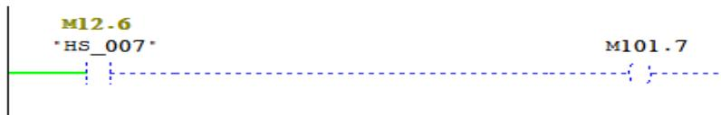
Réseau 6 : Alarme activation de système anti incendie sur le bac 2A
