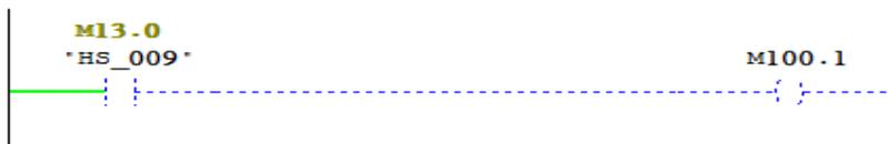
Réseau 5 : Alarme activation de système anti incendie sur le bac 2Y1
