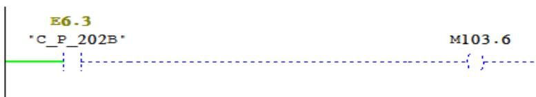
Réseau 5 : Alarme 'détecteur de température'
