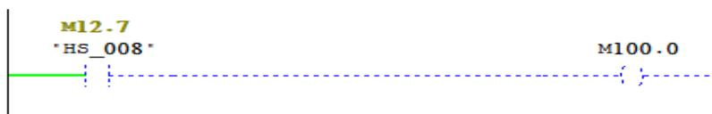
Réseau 7 : Alarme câble thermosensible de bac 2A2
