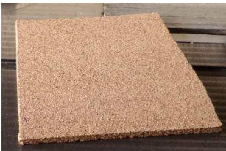
**Figure III.2 :** Liège aggloméré de moyenne densité
