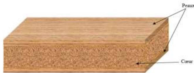
**Figure I.1 :** Schéma représentatif d'un sandwich
