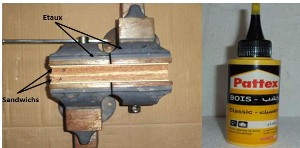
Figure III.4 : Assemblage des constituants du sandwich
