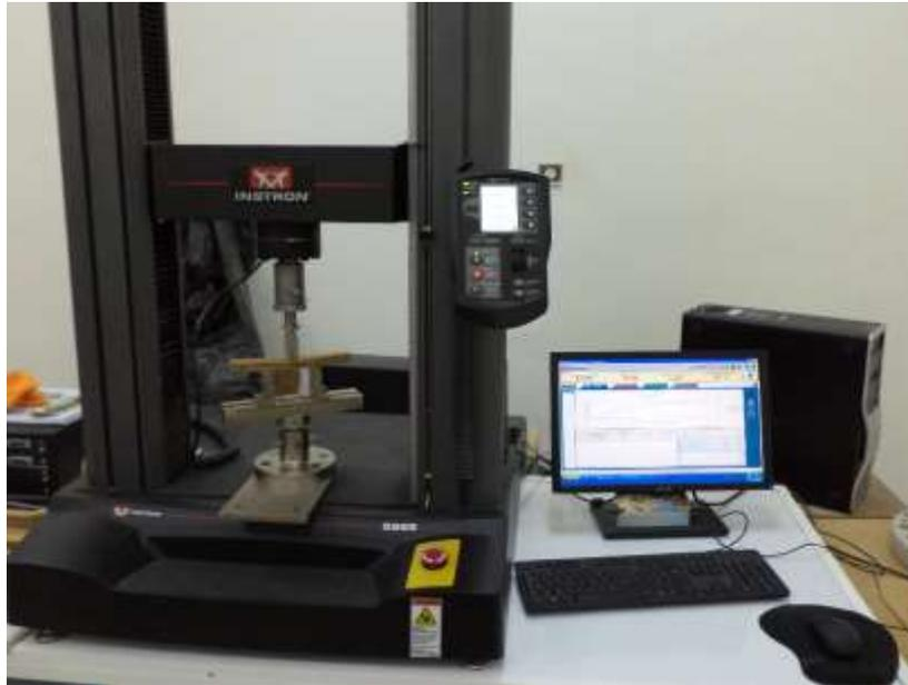
**Figure III.7 :** Machine universelle type INSTRON modèle 5969
