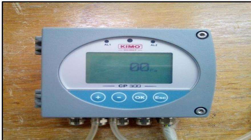
**Figure (II.4) : Capteur différentiel de pression.**
