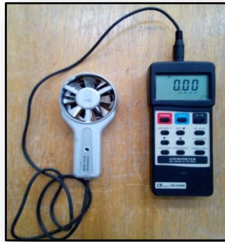
Figure (II.5) : Anémomètre a hélice.
