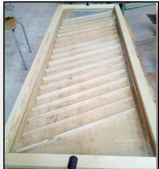
Figure (II.6) : La rugosité artificielle sous forme des nervures en bois.
